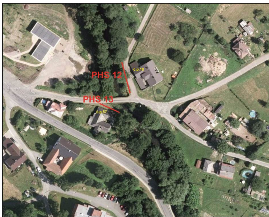
Obr. 36 Oblast Rybník: Lokalizace mobilní protihlukové stěny PHS 12 (délka 24 m, výška 2,9 m) nezbytné pro 2. etapu prací a mobilní protihlukové stěny PHS 13 (délka 17 m, výška 4 m) nezbytné pro 2. a 3. etapu prací
