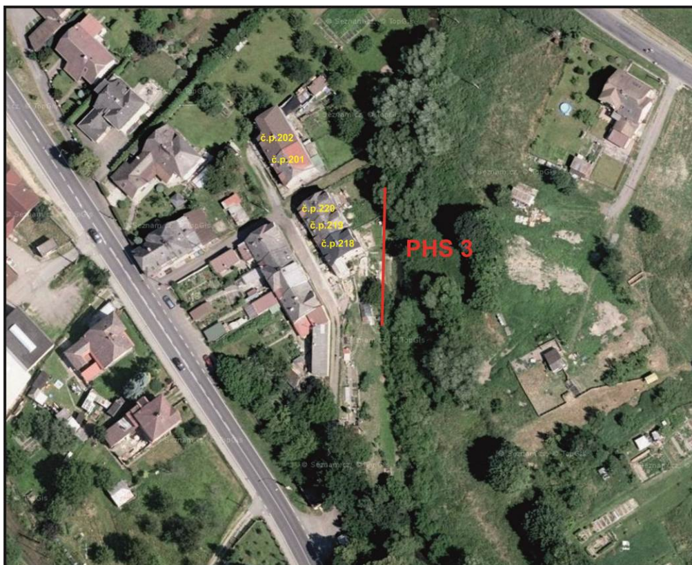
Obr. 30 Oblast Rybník: Lokalizace mobilní protihlukové stěny PHS 3 (délka 45 m, výška 4,5 m) nezbytné pro 1. etapu prací
