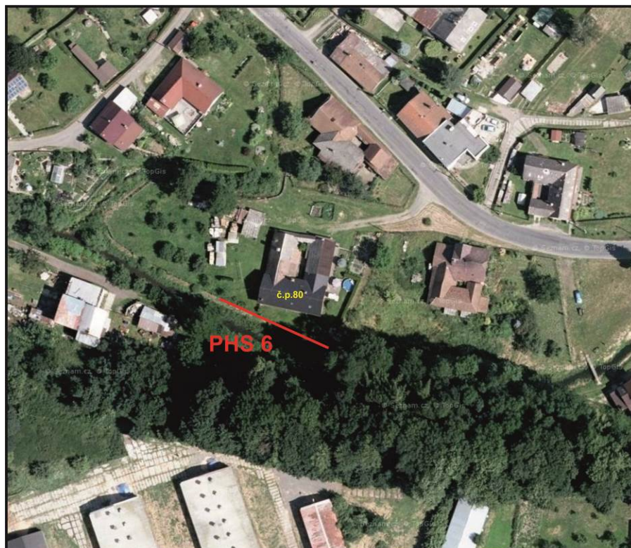
Obr. 32 Oblast Rybník: Lokalizace mobilní protihlukové stěny PHS 6 (délka 37 m, výška 2,9 m) nezbytné pro 3. etapu prací
