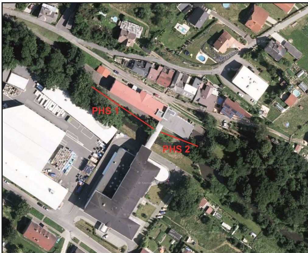
Obr. 27 Oblast Česká Třebová: Lokalizace mobilní protihlukové stěny PHS 1 (délka 55 m, výška 4 m) nezbytné pro 1. a 2. etapu prací a mobilní protihlukové stěny PHS 2 (délka 30 m, výška 4 m) nezbytné pro 2. a 3. etapu prací
