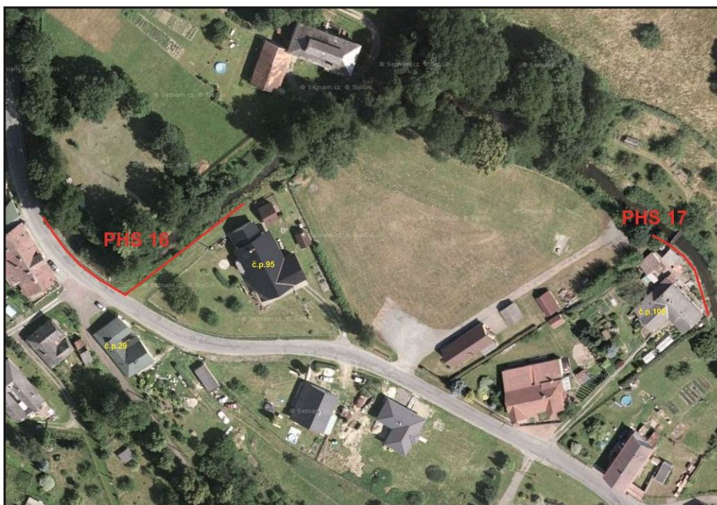
Obr. 38 Oblast Rybník: Lokalizace mobilní protihlukové stěny PHS 16 (délka 95 m, část stěny podél komunikace je dlouhá 40 metrů, část stěny kolmá na komunikaci je 55 metrů, výška 2,9 m) nezbytné pro 1. etapu prací a mobilní protihlukové stěny PHS 17 (délka 40 m, výška 4,5 m) nezbytné pro 1. etapu prací
